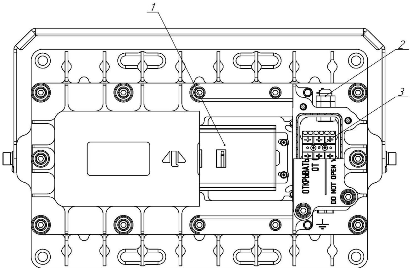
1 – источник питания; 2 – кабельный ввод; 3 – колодка клеммная.
